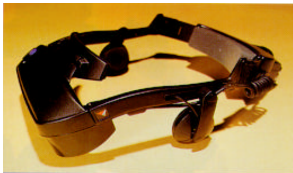
Figura 3-2: No HMD existem sensores (parte de trás do equipamento) que captam os movimentos da cabeça do usuário permitindo que o computador gere a imagem apropriada.
